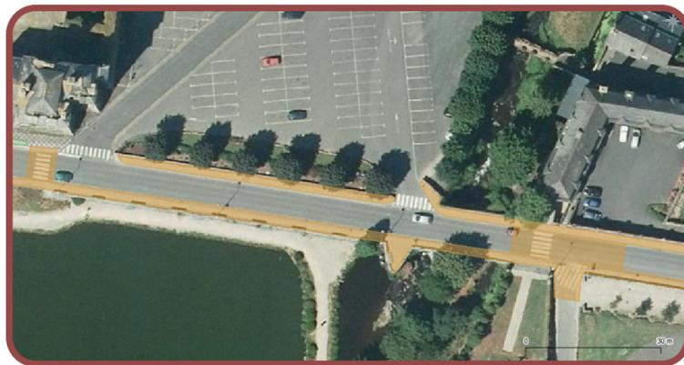
Aménagement proposé (2 plateaux permettant de traverser l'avenue, pose d'enrobé hydrodécapé sur les trottoirs et pose d'un dallage en granite au pied du Château).
